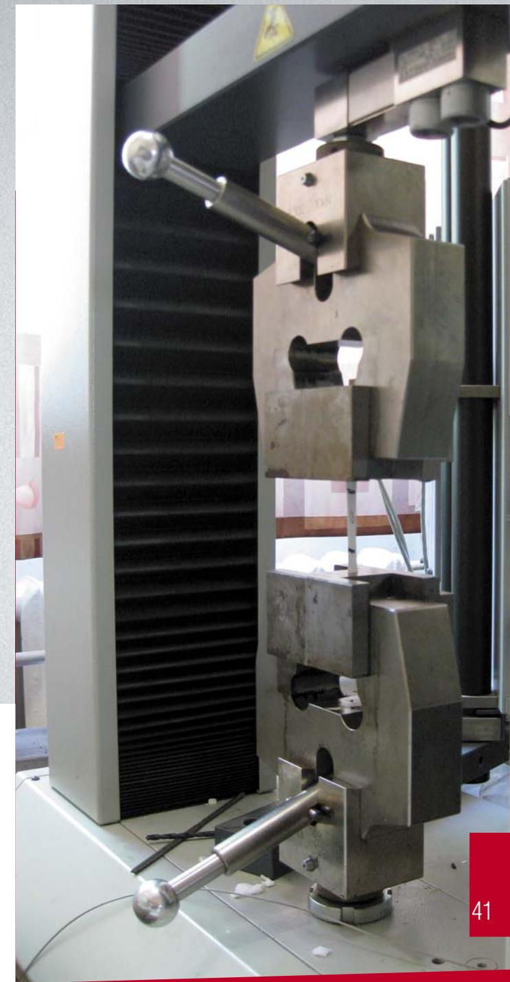
41 Материалы для протезирования, полученные методом электроспиннинга, прошли испытания на прочность на разрывной машине Zwick/Roell Z100 в Центре коллективного пользования «Механика» ИГиЛ СО РАН. Фото А. Лебедевой
